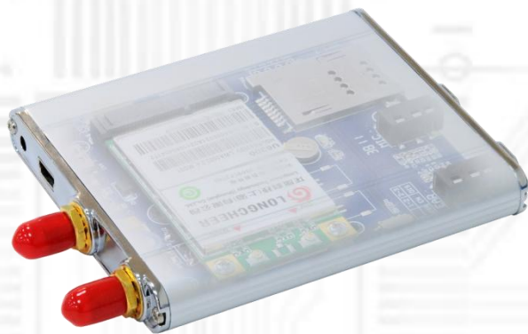
USBMS-N15 (3.5G データ通信 USB モデム) x1 LONGCHEER 製 HSUPA MiniCard 内蔵
