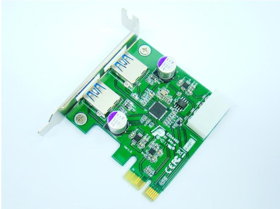
PP1U/PP2U はメインコントローラ IC としてルネサス製最新の USB3.0 コントローラ IC である  $\mu$ D720202 を採用しています。 $\mu$ D720202 は市場で最も採用されている  $\mu$ D720200 および  $\mu$ D720200A のアップデート版です。
