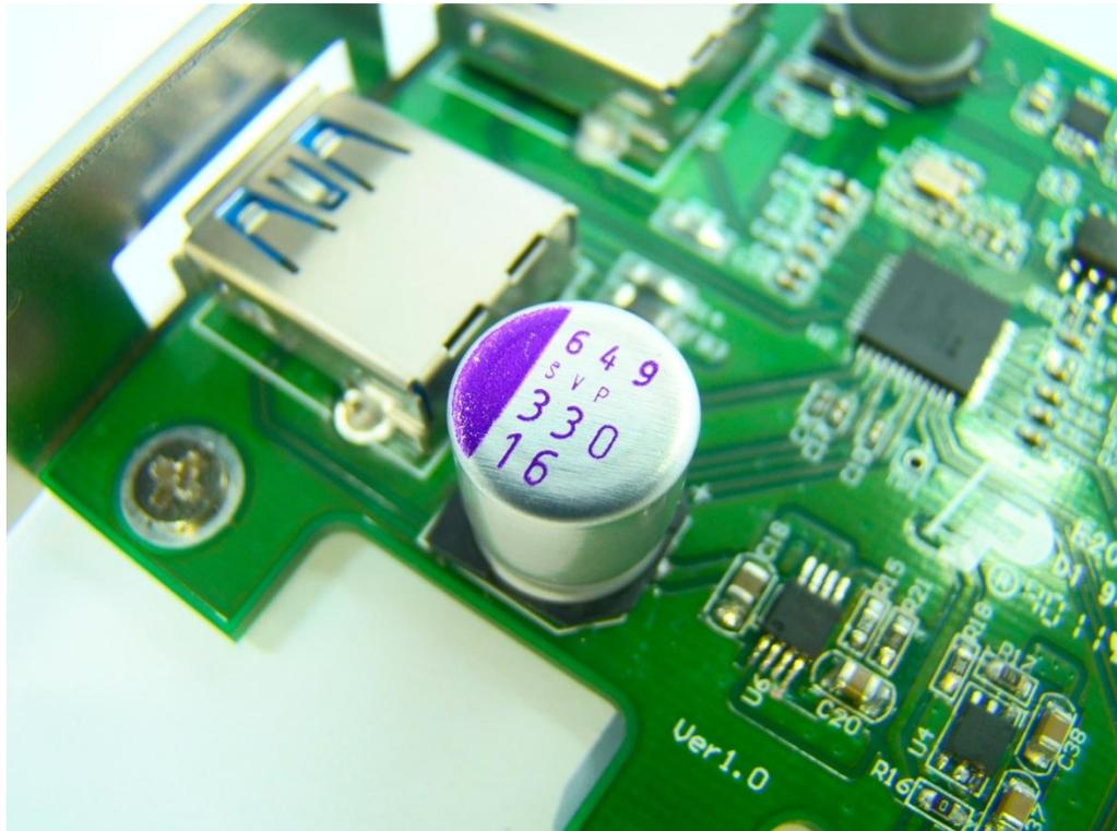
PC 関係の周辺機器ではコンデンサの選択は特に重要です。他社の USB3.0 拡張ボードと比較して、PP1U/PP2U シリーズの標準版は、コンデンサの容量を増加させ、さらに最新の強化版では電源に三洋製の固体コンデンサを採用し、品質を向上しています。
